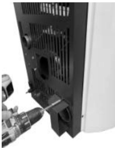
Fig. 70 - Extracción del desviador
