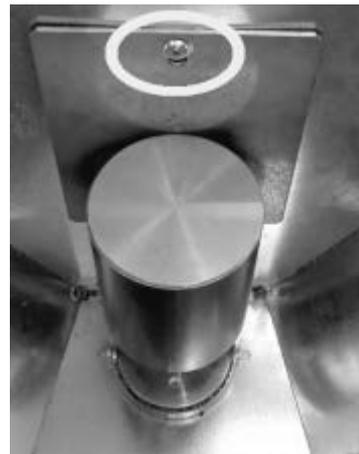
*Fig. 103 - Retirada del tornillo*
