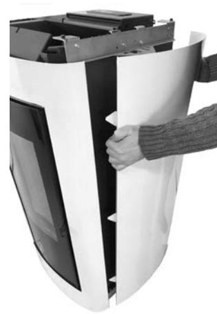
*Fig. 50 - Extracción de la pared lateral*
