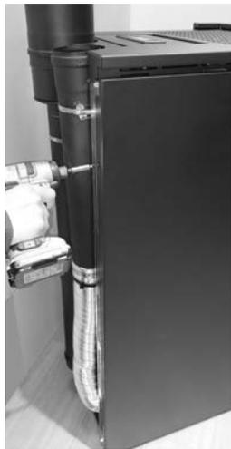
*Fig. 33 - Extracción de los tornillos traseros*
