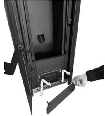
**Fig. 39 - Extracción del panel frontal traseros**
