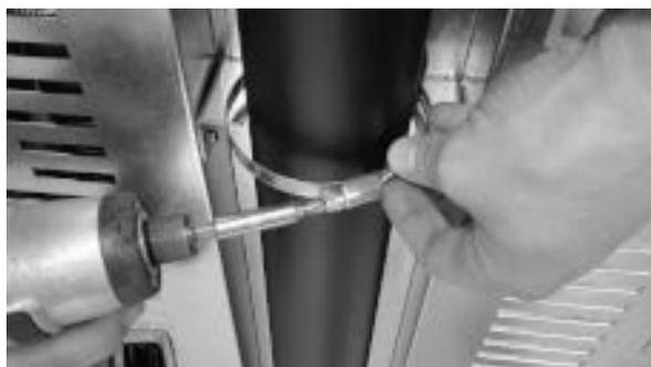
*Fig. 65 - Bloquee con la abrazadera*
