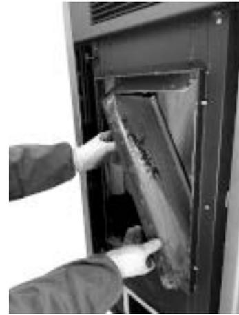
**Fig. 92 - Retire las paredes laterales**
