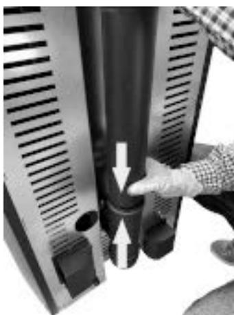
*Fig. 60 - Conecte los tubos*
