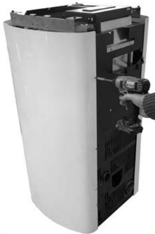
*Fig. 49 - Extracción de los tornillos traseros*
