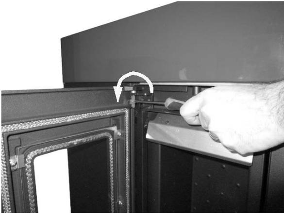
**Fig. 21 - Extracción de los tornillos**
