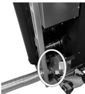
Fig. 73 - Bloquee el tubo flexible
